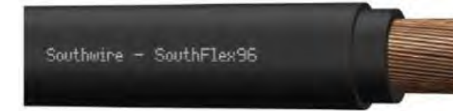
1/C CU 0,6/1kV HEPR/PVC CLASE 5 90°C TC
