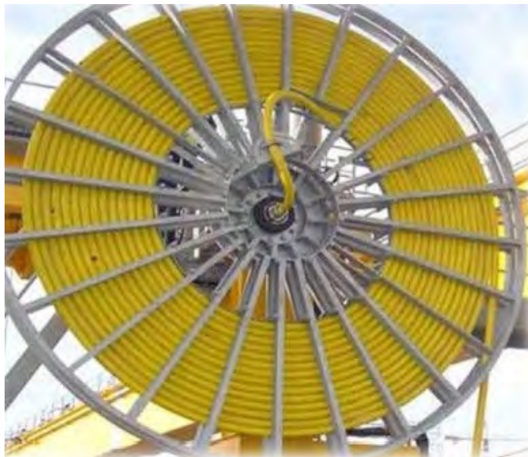
Cables de Potencia de medio Voltaje
